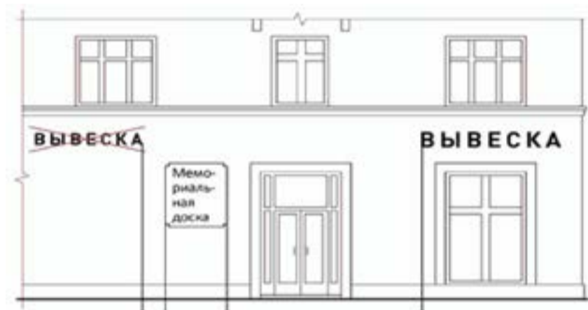
18.9. Перекрытие указателей наименований улиц и номеров домов (пункт 1.10.1 Правил).
